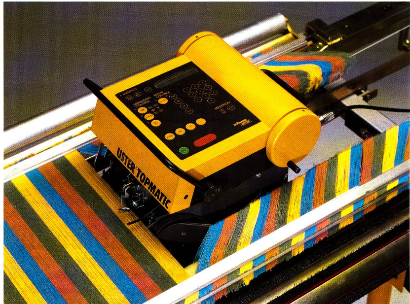
Die Uster Topmatic PC mit mikroprozessorgesteuerter Doppelfadenabstimmung ohne Verwendung eines Fadenkreuzes.
