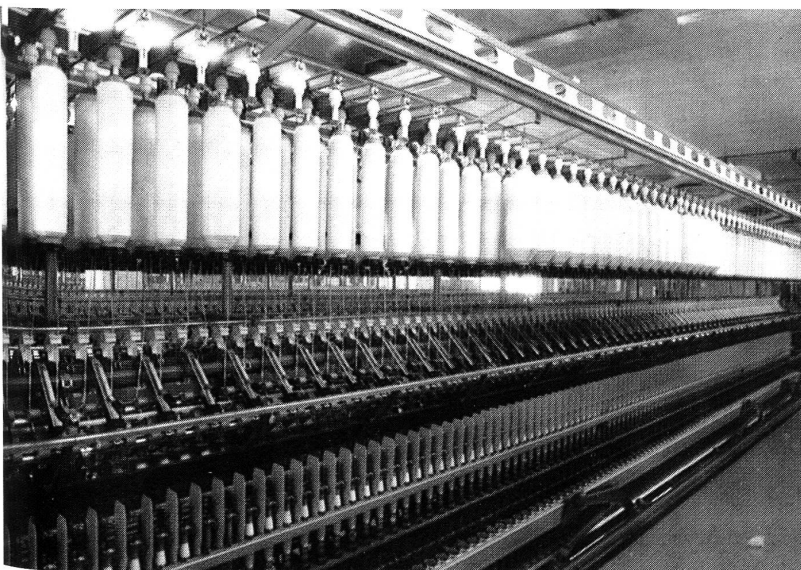
17 neue Rieter-Ringspinnmaschinen G5/2 mit 20 000 Spindeln stehen im vertikalen Direktverbund mit 17 Murata-Spulmaschinen. Bild: mittex
