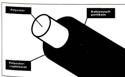
Bei der Epitropic-Faser der ICI handelt es sich um eine kohlenstoffbeschichtete Bikomponentenkonstruktion mit einem Polyesterkern und einem Polyesterisophthalatmantel. Die feinen, in der Faseroberfläche eingebetteten Kohlenstoffpartikel verhindern eine elektrostatische Aufladung und garantieren eine konstante Ableitung.
