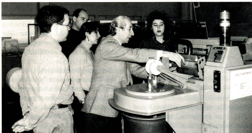
Prof. Bar-Yecheskel vom Shenkar College bei der Erläuterung der Nadelstabs- strecke an der STF Wattwil.
