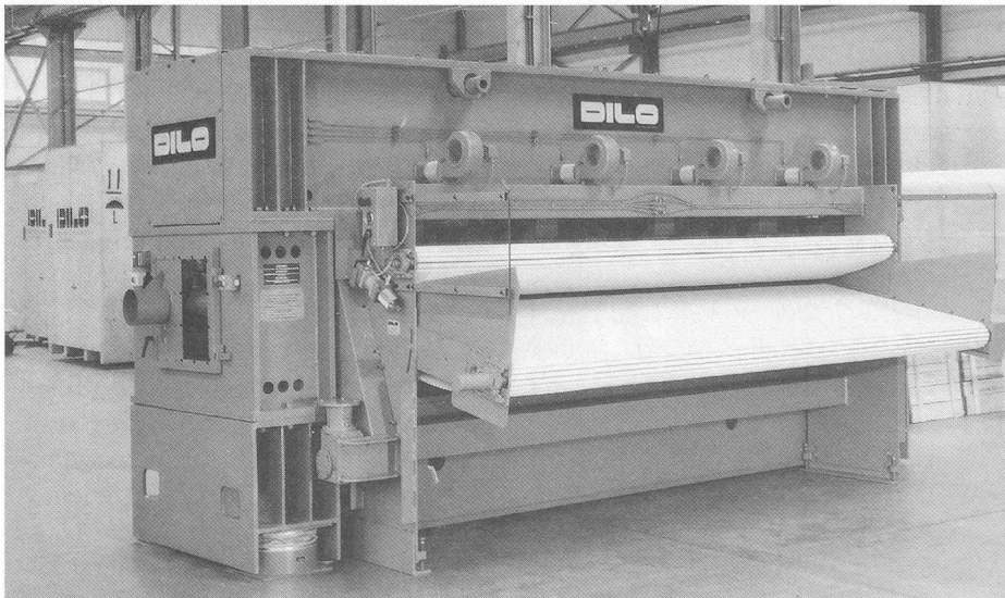
DILO-Doppelnadelmaschine DI-LOOM OUG-II/S mit Vlieszuführsystem CBF.
