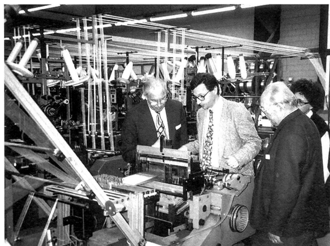
Direktor Kurt Hagenbuch demonstriert einen modernen Nadelbandwebautomaten
