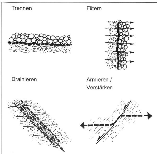
Abb. 3: Hauptaufgaben von Geotextilien
