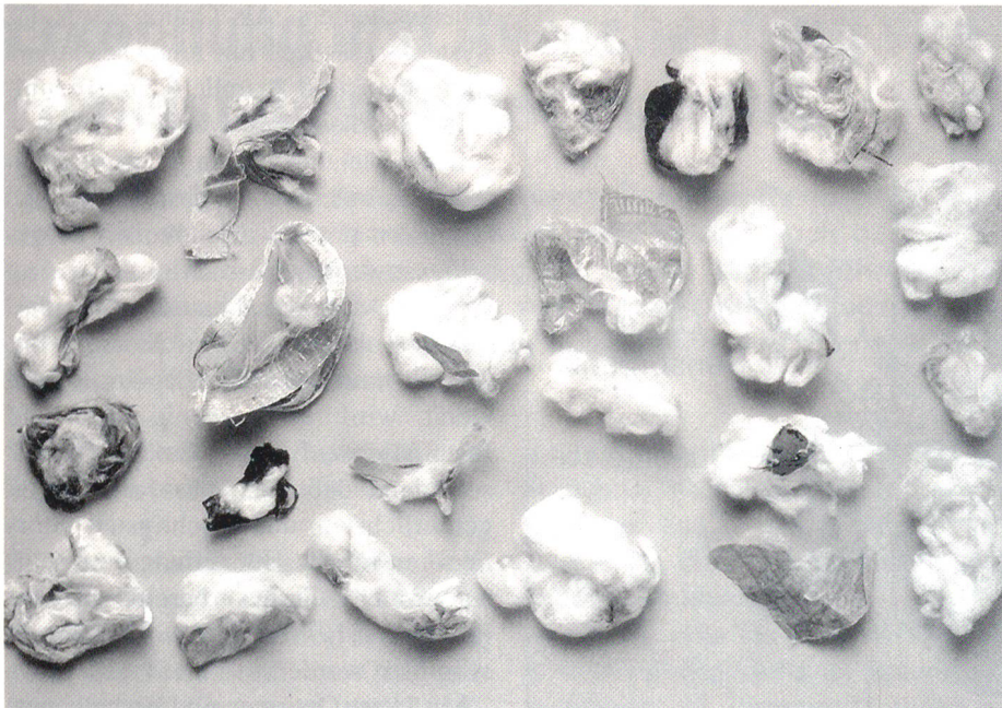
Bild 4: Beispiele von ausgeschiedenen Fremdstoffen durch USTER® OPTISCAN, bei der Firma Schoeller/Deutschland
