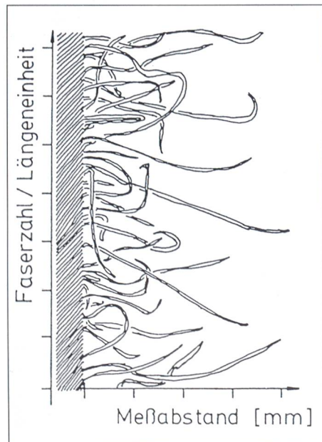
Abb. 1: Darstellung des Messprinzips des Zweigle-Haarigkeitsgerätes.
