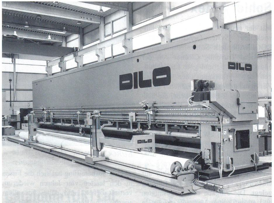
Nadelmaschine, Typ DI-LOOM OD-I (P) 154
