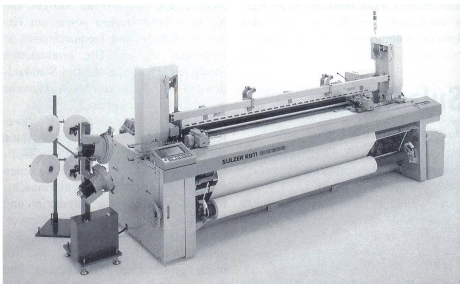
*Luftdüsenwebmaschinen L5200**Foto: Sulzer Rütli*
