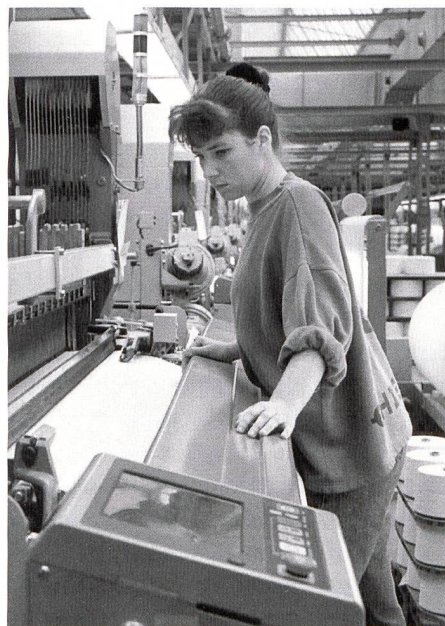
Luftdüsenwebmaschinen L5200 bei Mayfair Mills, USA Foto: Sulzer Rütli
