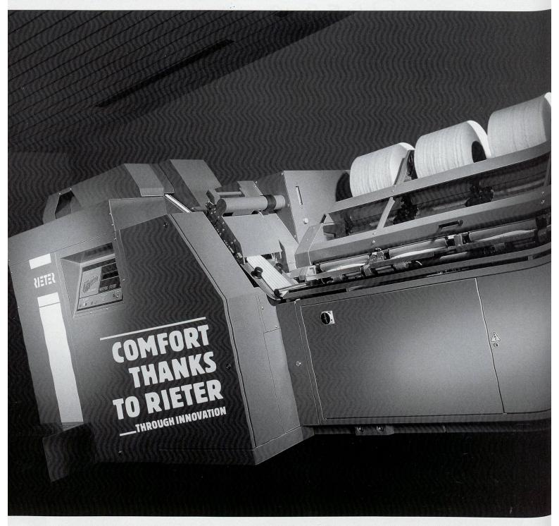
E 60 H: Die Kämmmaschine für eine Tonne pro Tag
