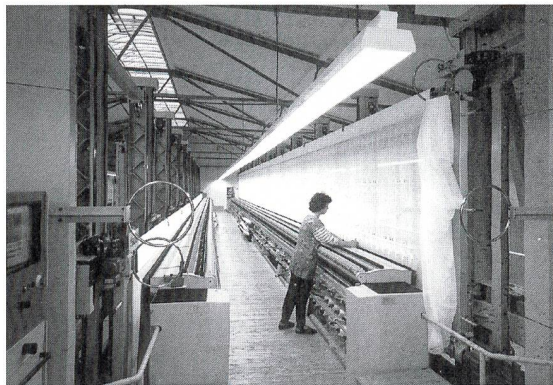
Ein Stickereibetrieb mit insgesamt 4 Hochleistungs-Schiffchenstickmaschinen Saurer Epoca. Fotos: Saurer Textile Systems
