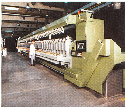
Autoconer 338 mit automatischem Materialfluss (alle Fotos: Schlafhorst)
