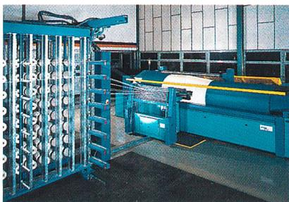
Abb. 2: Schärmaschine BEN-TRONIC
