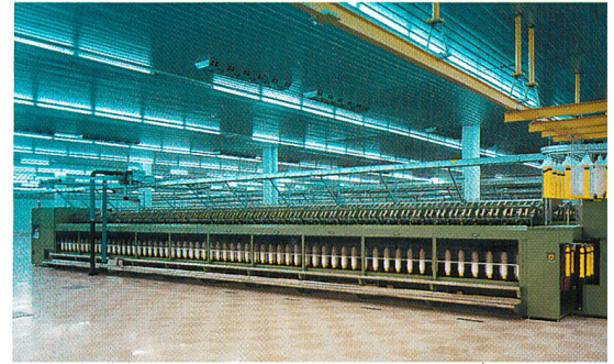
Abb 2: RO-WE-MAT 670 – Flyer mit integriertem Spulenwechsler
