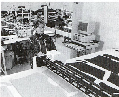
Abb. 5: Einzellagencutter für den Individualzuschnitt
