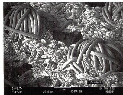
Strukturierte Oberfläche eines Wundpads (Rasterelektronenmikroskopische Aufnahme)
