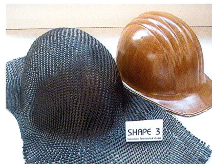
3D-gewebte Helmschale «Schutzhelm»
