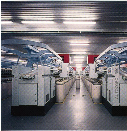
Eine Autocoro-Anlage im Betrieb
