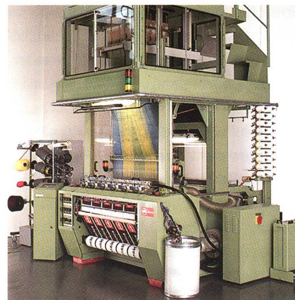
Moderne Luftdüsen-Webmaschine in SILENT-Ausführung für die Schalproduktion
