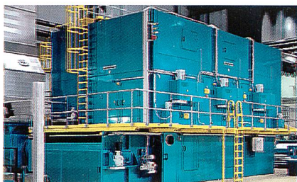
Abb. 2: Hochleistungs-Durchströmtrockner für die Vliesstoff-Industrie (Quelle Internet)
