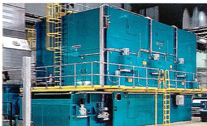
Abb. 2: Hochleistungs-Durchströmtrockner für die Vliesstoff-Industrie (Quelle Internet)
