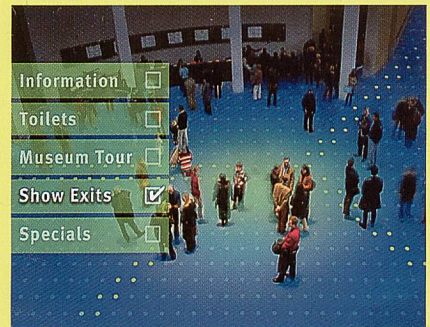
Teppichboden mit integrierter Sensorik, um Besucherströme zu kontrollieren und zu leiten, Bildnachweis: Infineon Technologies AG, München
