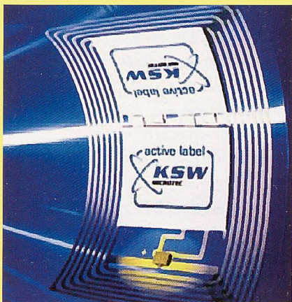
RFID-Transponder, Bildnachweis: KSW Microtec AG, Dresden
