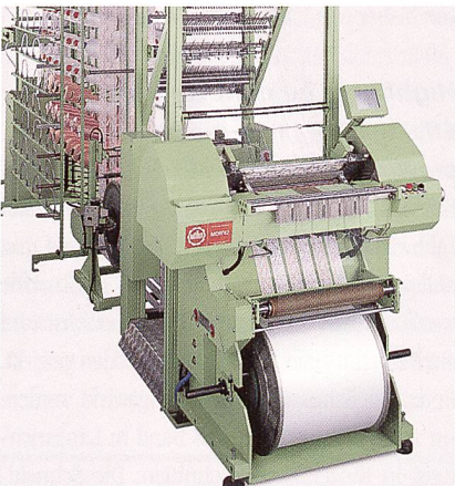
Abb. 7: Die MDR42 wird mit 8 bis 24 Legebarren geliefert
