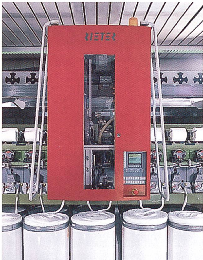
Abb 1: Der Roboter der R 40: Seine präzise und schnell arbeitenden Module sind verantwortlich für die hohe Ansetzerqualität
