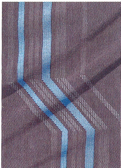
Abb. 8: Power-Net-Produkt mit Elastan 235 dtex und mit 1cm-breiten Elastanstreifen mit der Feinheit von 280 dtex
