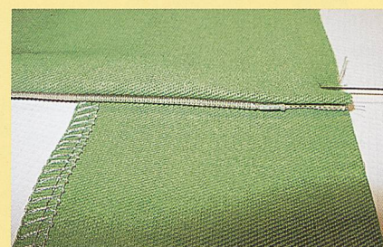
Oberstoff leicht deckend an RV stecken
