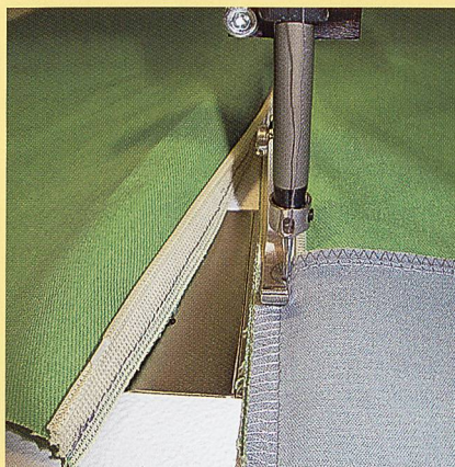
Beleg mit RV-Nähfuss verstürzen
