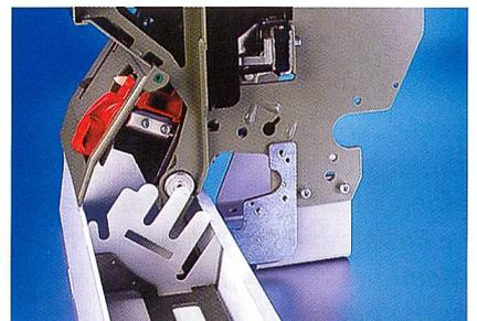
Abb. 4: Optimierte Trass-Ausscheidung für die Corobox SE 11 für Autocoro mit Spinnboxen SE 9 und SE 10
