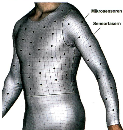
Abb. 2: Konzept für die Erkennung von Körperhaltungen mit Mikrosensoren und Sensorfasern in der Bekleidung
