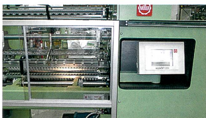
Abb. 2: Die kompakte Raschelmaschine MDK80 mit bedienungsfreundlichem Touchscreen
