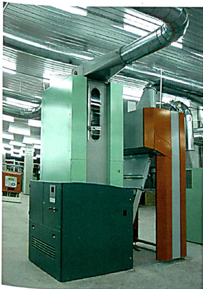
Abb. 6: Speicher- und Speiseeinheit UNIstore A 78
