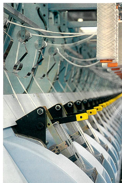
Das Maschinenfeld: «Ein Kilogramm Garn ist auf der WinSpin in einer Stunde und auf der WinTwist in zwei Stunden produziert. Alles in allem beträgt die Produktionszeit von den Finisseurspulen bis zum fertigen Zwirn drei Stunden»
