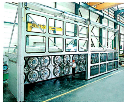
Abb. 1: Fleissner Kalander mit Einhausung in der Endmontage
