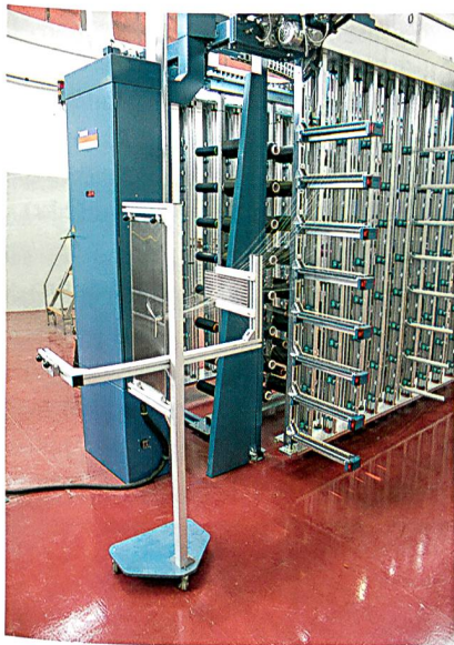
Abb. 5: Rüstwagen für Fadenführung, Gelese- und Schärblatt
