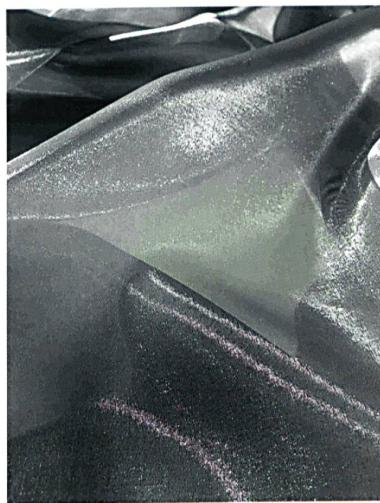
Abb. 5: Nanometall-beschichteter Vorhangstoff MASA aus Trevira CS von Suzutora Corporation, Japan (Kollektion: TORA-JU)
