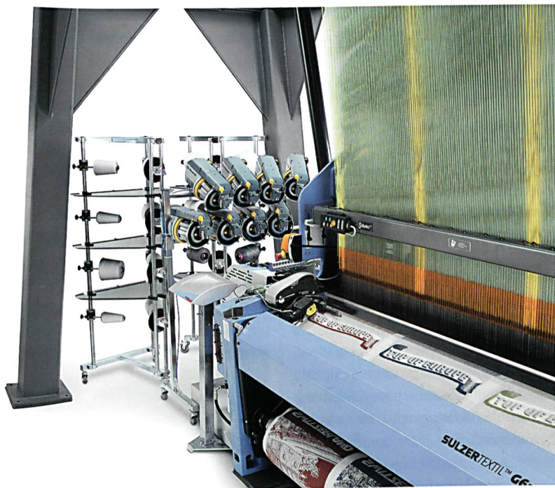
Abb. 2: Die Sulzer Textil Greiferwebmaschine G6500F ist die Frottierwebmaschine, die höchsten Ansprüchen bezüglich Gewebequalität und Leistung gerecht wird
