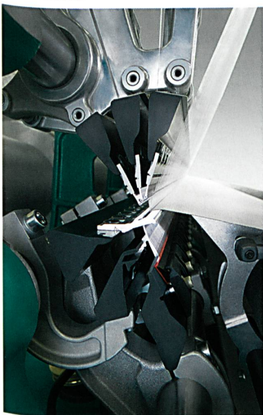
Abb. 1: Karbonbarre an der HKS 3-M, ein Exponat von KARL MAYER zur ITMA in München
