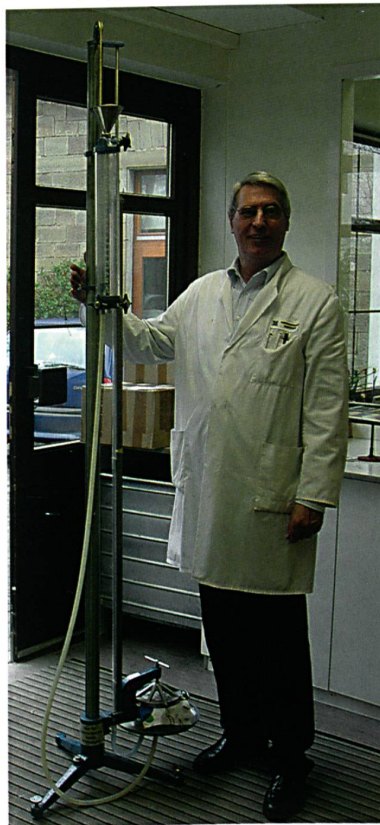
Abb. 1: Die «Wassersäule», in die Jahre gekommenes Messgerät zur Ermittlung der Wasserdichtheit von Textilien
