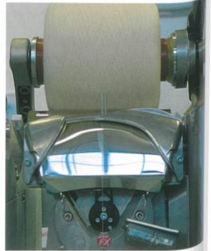
Abb. 7: Individuelles Kantendesign bei Färbespulen für Prozesskettenverkürzung
