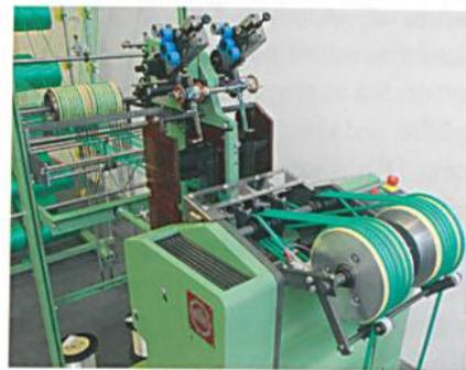
Abb. 1: Die neue Nadelband-Webmaschine für MultiSphere-Produkte NG3M
