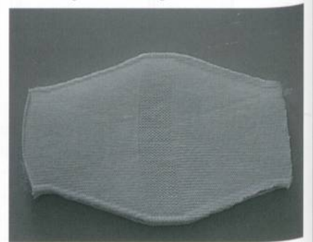
Abb. 2: Textiles 3D-Bauteil nach dem Trennen
