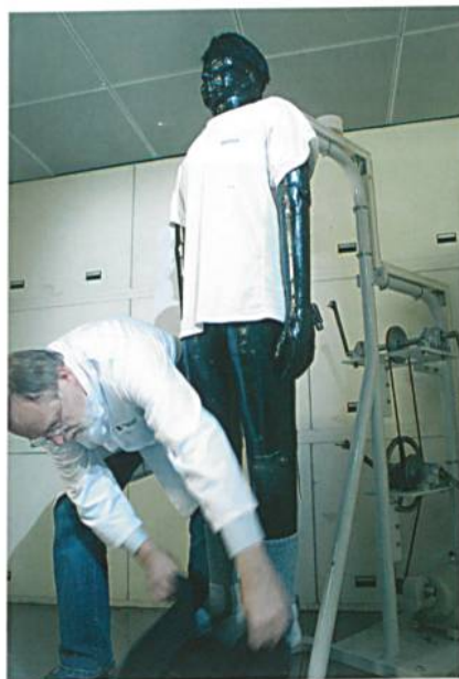
Abb. 2: Mit der Gliederpuppe «Charlie» wird an den Hohenstein Instituten u. a. der Tragekomfort von Kleidung untersucht und optimiert
