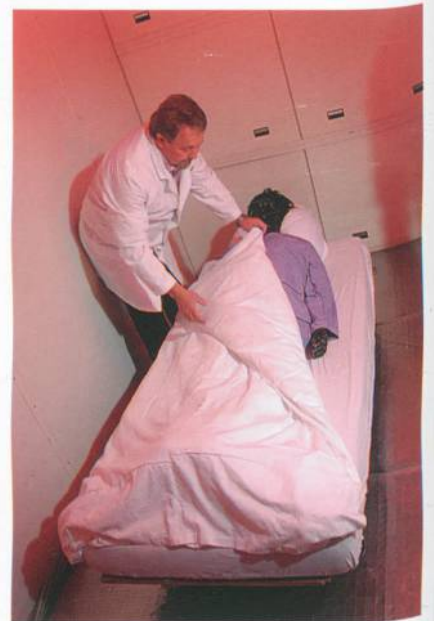
Abb. 3: Mit Hilfe der Gliederpuppe «Charlie» werden die thermophysiological Eigenschaften konfektionierter Kleidung oder von Bettdecken gemessen
