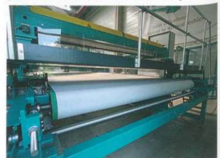
Abb. 1: Durchgängige Transportauflage am Eingang der Maschine
