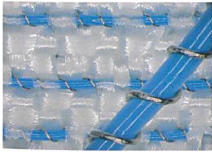
Abb. 1: Doppelgewebe mit patentierter Metallverstärkung für zusätzlichen Grip (Foto: RUD PR)
