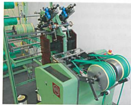
Abb. 1: Die neue Nadelband-Webmaschine für MultiSphere-Produkte NG3M
