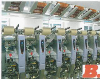
Abb. 5: Der Autoconer 5 mit PreciFX spult zuverlässig Qualitätskreuzspulen für die anspruchsvolle Kundschaft der Hermann Bühler AG
