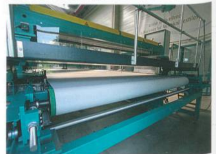
Abb. 1: Durchgängige Transportauflage am Eingang der Maschine
