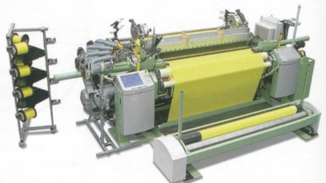
Abb. 2: Die Dornier P1 Greiferwebmaschine mit einem Artikel aus Aramidfilamenten
