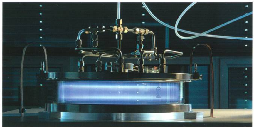
Abb. 1: Da Silberionen nicht nur Bakterien abtöten, sondern auch menschliche Zellen schädigen können, sind Schichten gesucht, die genau das therapeutische Fenster der Silberionen nutzen. Empa-Forschende entwickeln als Lösung neuartige nanostrukturierte Polymere mit eingebauten Silber-Nanopartikeln
