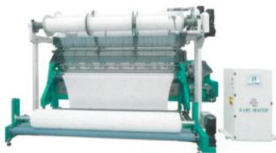
Abb. 1: Die erste Raschelmaschine mit CFK-Ausstattung, die RSE 4-1
