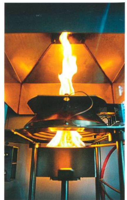
Abb. 2: Cone Calorimeter Tests nach ISO 5660-1
