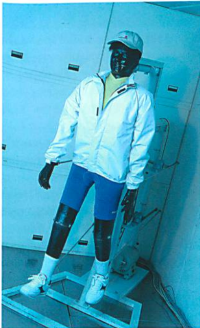
Der Tragekomfort von Sportbekleidung aber auch sonstiger Textilien erfolgt an den Hohenstein Instituten u. a. mit Hilfe der thermischen Gliederpuppe Charlie
